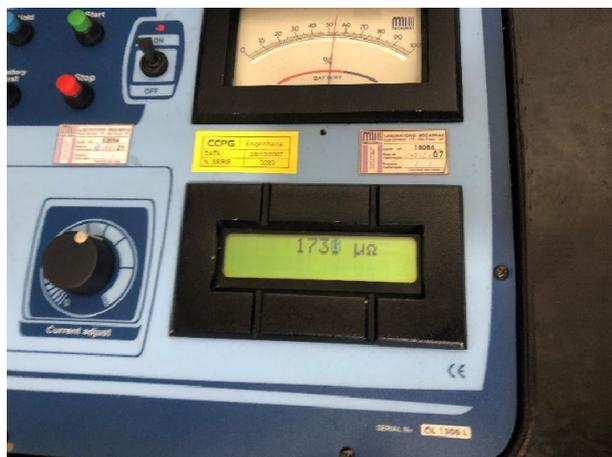
Foto 3 – resistência medida no ensaio
