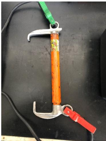
Foto 2 – bypass para 27kV em ensaio
